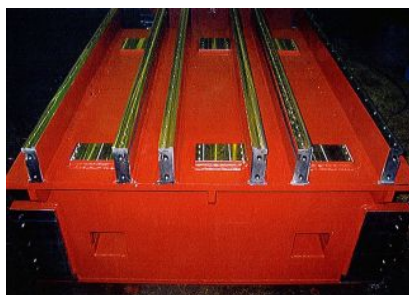
◎実験装置の上面テーブル（ステンレス）→
