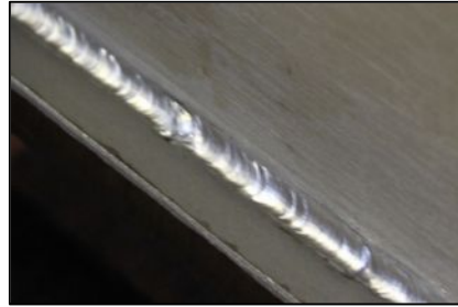
ステン溶接焼け 酸洗後
